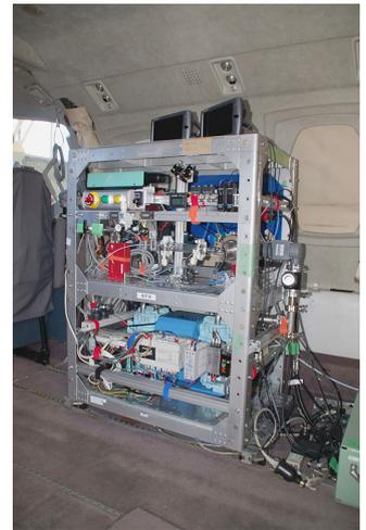
図2 いつでもどこでも製造～飛行機(MU300)に乗ったAD製膜装置
